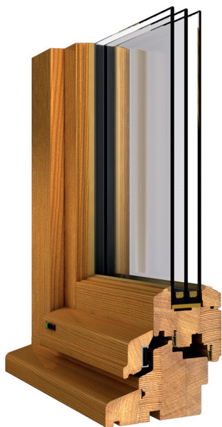
Darstellung: Bautiefe 80 mm Nadelholz / 3fach Isolierverglasung
