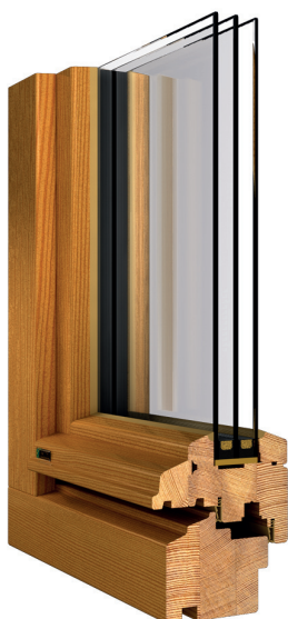
Darstellung: Bautiefe 80 mm Nadelholz / 3fach Isolierverglasung
