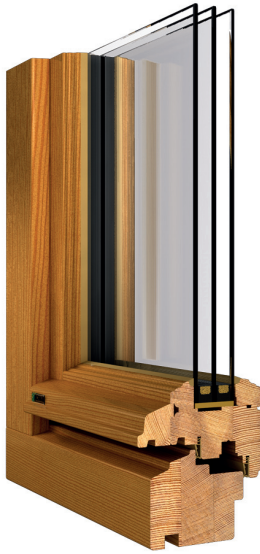
Darstellung: Bautiefe 80 mm Nadelholz / 3fach Isolierverglasung
