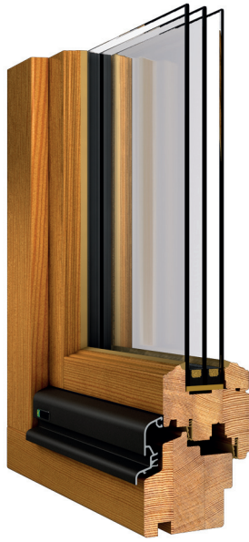
Darstellung: Bautiefe 80 mm Nadelholz / 3fach Isolierverglasung
