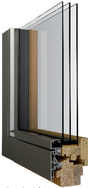
Darstellung: Bautiefe 95 mm Eiche / 3fach Isolierverglasung
