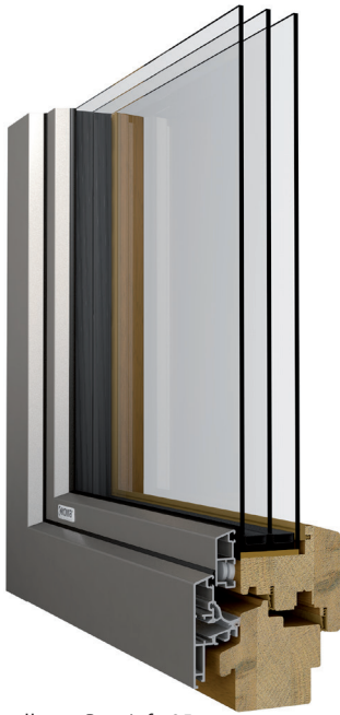
Darstellung: Bautiefe 95 mm Eiche / 3fach Isolierverglasung
