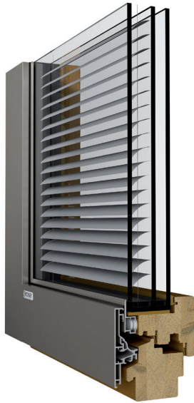
Darstellung: Bautiefe 95 mm / Jalousien im SZR optional Flügel- schale farblich angepasst optional Eiche / 3fach Isolierverglasung
